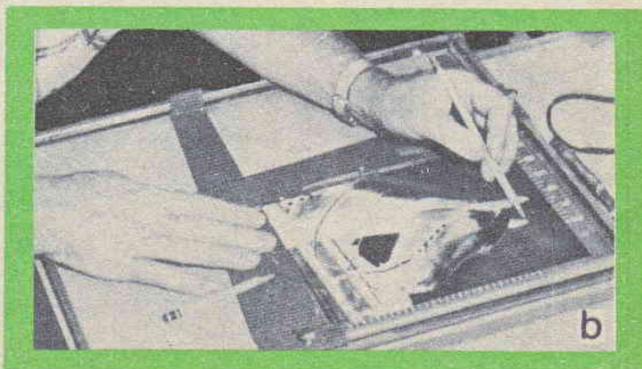
Il particolare A mostra la foto originale, il particolare B mostra una fase della lavorazione nella quale si vede l'applicazione della grafite sulle varie zone del negativo a grande formato che si adotta come intermedio. Una volta terminata l'applicazione della grafite e tolta la immagine fotografica negativa, la figura a grafite appare come nel particolare illustrato nella fig. C
